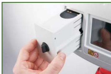
Рис. 3 Батарея Leica GEB241
