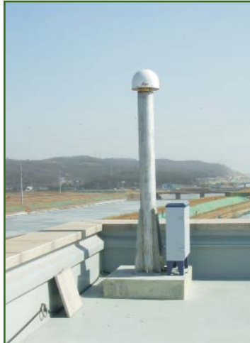
Рис. 2 Базовая станция на крыше центра мониторинга
